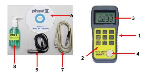
1) Base Instrument 2) Keypad 3) LCD display 4) Calibration Block 5) Dual Sensor Probe 6) Software 7) USB Output Cable 8) Couplant Gel
